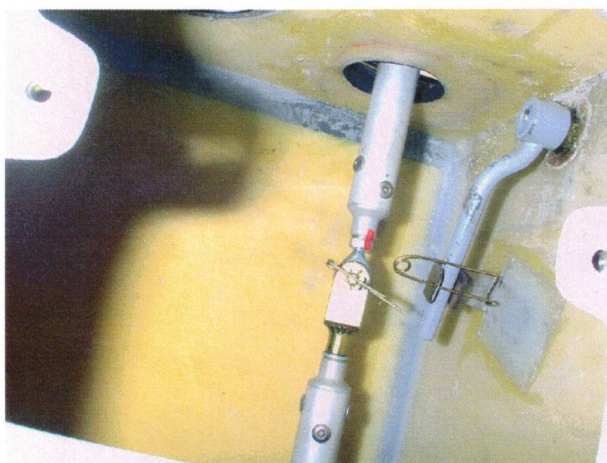
Obr. 2. Vonkajší hlavný spojovací čap krídla a spoj tiahla krídeliek pravého krídla
