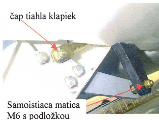
Obr.3. Umiestnenie a zaistenie čapu klapiek, umiestnenie samoistiacej matice M6 s podložkou na čape závesu klapky
